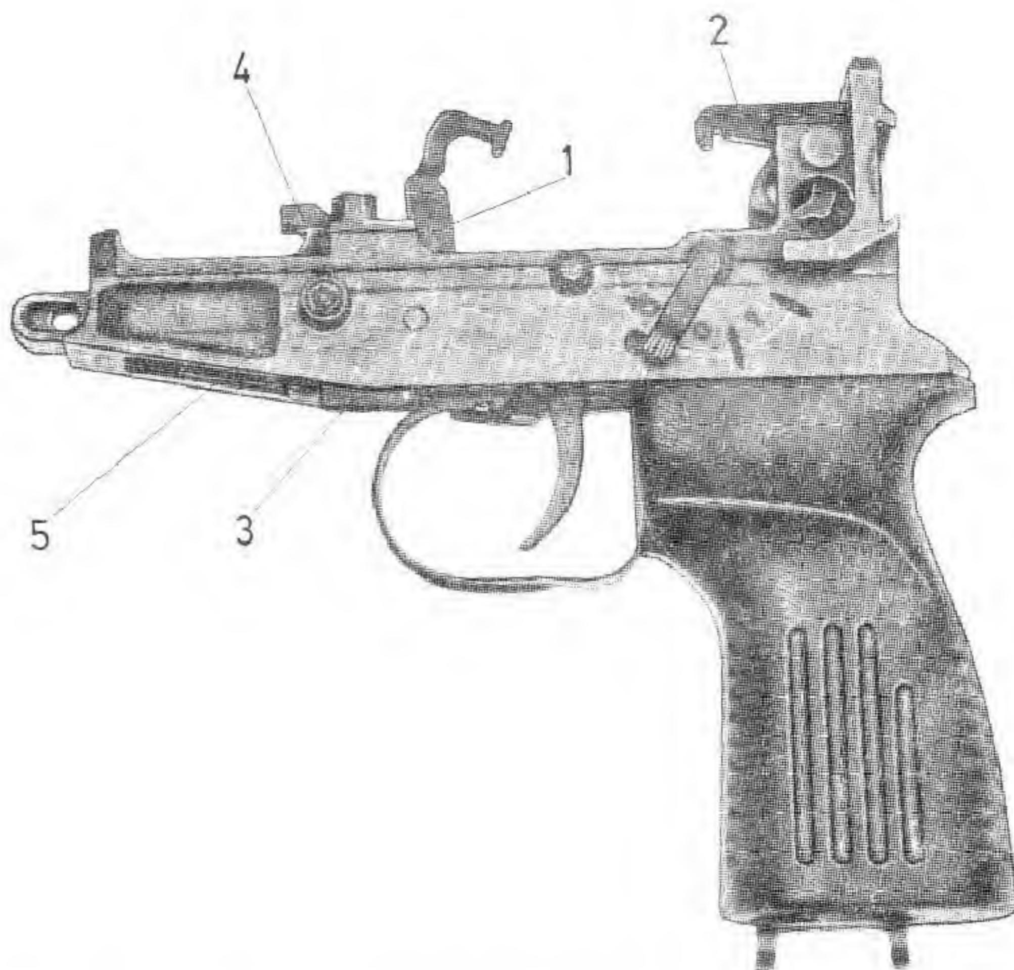
Sl. 5 – **Usadnik, (sklop) sa delovima mehanizma za okidanje, usporenje brzine gađanja i zadržavanje zatvarača:**
